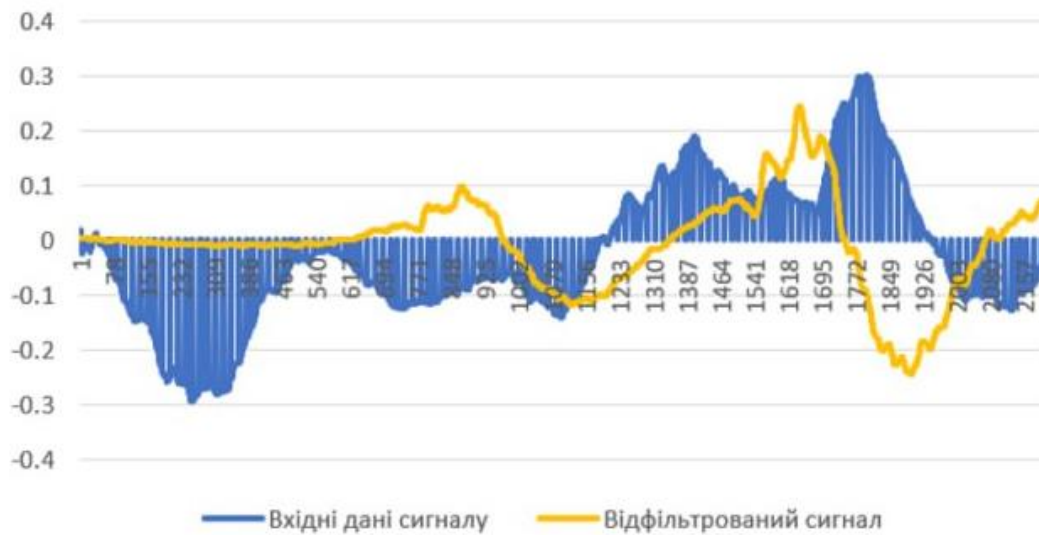
Рис.1 Початкові вхідні значення (сині) та отримані за допомогою фільтрації, побудованій на стандартних перетвореннях Фур'є (жовті)
