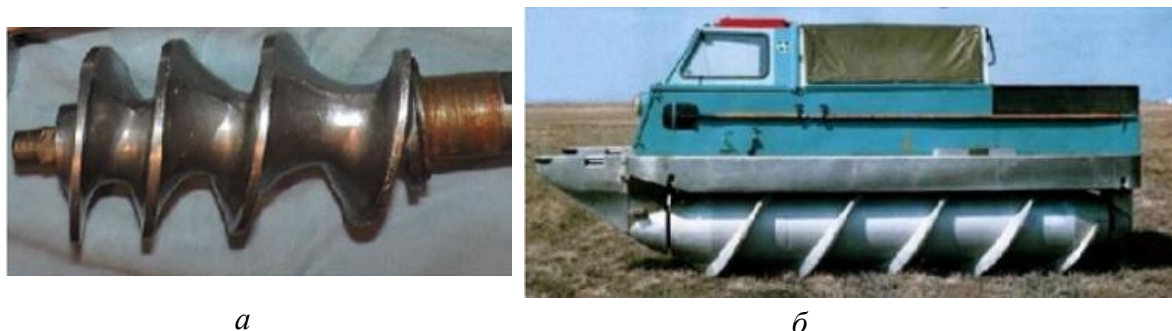
Рис. 14. Геометричні моделі на базі спіралі Архімеда: a - шнек м'ясорубки; б - колеса всюдихода.
